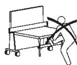
Ne pas prendre appui sur la traverse ou sur les pieds pour tirer la poignée rouge de déverrouillage, risque de basculement.
